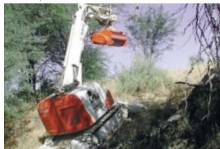
MAXX in schwierigem Gelände: Hier mit einem hydraulischen Vegetationsschneider.
