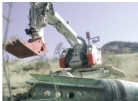
Gleich eine ganze Reihe verschiedener Werkzeuge können mit dem ferngesteuerten Multitalent MAXX gefahrlos in den Minenfeldern eingesetzt werden.
